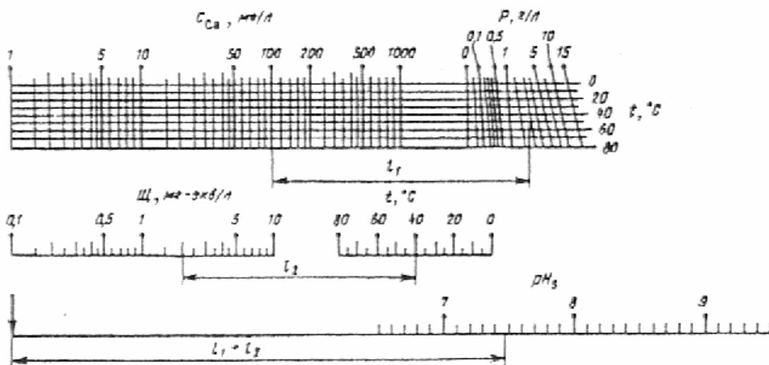
Рис. 1. Номограмма для определения pH насыщения воды карбонатом кальция (pH<sub>s</sub>)
