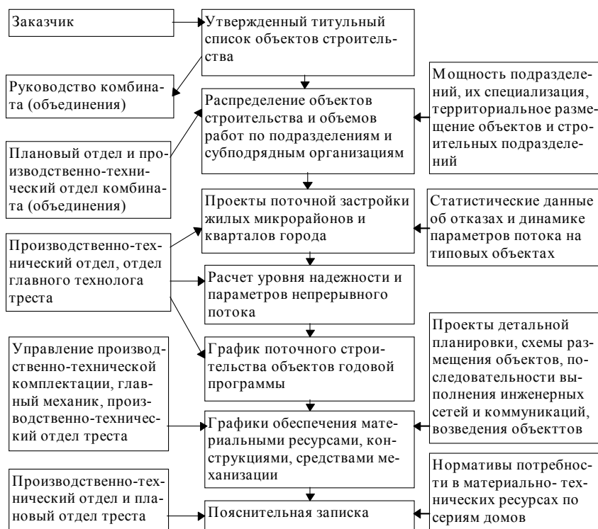
Рис. 17. Порядок разработки документации по организации работы комбината (объединения) непрерывным потоком
