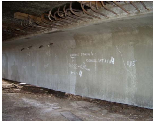
Рис. 6. Момент испытания новой балки по типовому проекту 3.503.1-73
