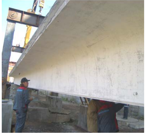
Рис. 5. Подготовка к испытаниям до разрушения и осмотр испытанной балки длиной 21 м:
