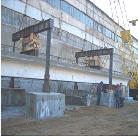
Рис. 5. Подготовка к испытаниям до разрушения и осмотр испытанной балки длиной 21 м:
