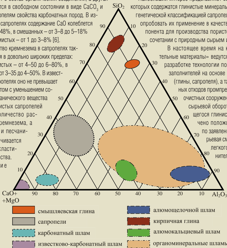
Рис. 1. Трехкомпонентная диаграмма состава минеральной части глинистого и корректирующего сырья для производства легкого пористого заполнителя
