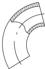
Рис. 16.1. Отвод крутоизогнутый, угол 45^\circ
