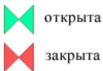
Задвижка в однолинейном изображении представляется одним узлом, но во внутреннем представлении в зависимости от заданных параметров в семантической базе данных, может быть установлена на обоих трубопроводах [Рисунок 2.23, «Однолинейное и внутренне представление задвижки»](#).
