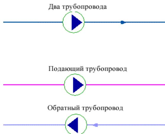
**Рисунок 2.17. Сверху: однолинейное изображение сети, снизу – внутреннее представление.**
