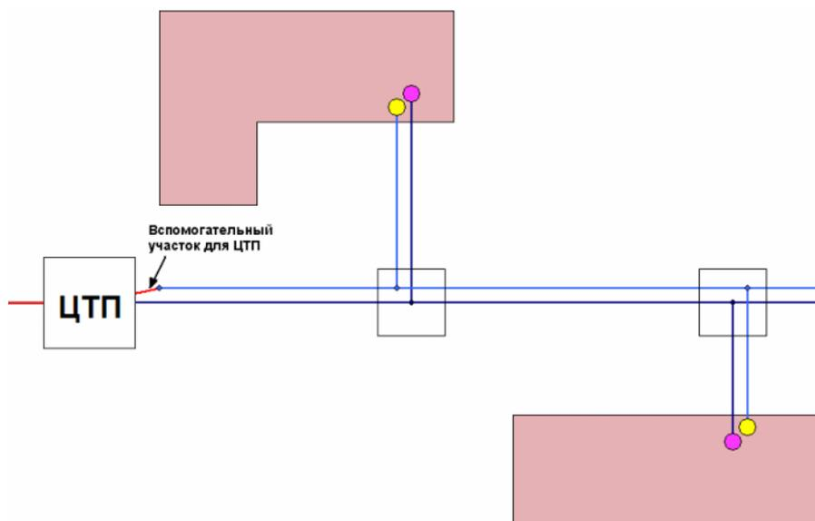
**Рисунок 2.16.** Однолинейное изображение четырехтрубной сети после ЦТП
