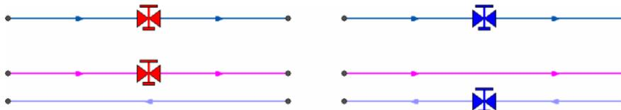
**Рисунок 2.32. Сверху: однолинейное изображение сети, снизу – внутренне представление**
