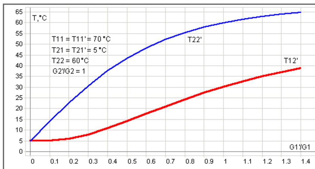
Используя испытательные параметры теплообменного аппарата, в расчете можно моделировать регулятор температуры, поддерживающий постоянную температуру воды на выходе второго контура при изменении температуры на входе первого контура.
