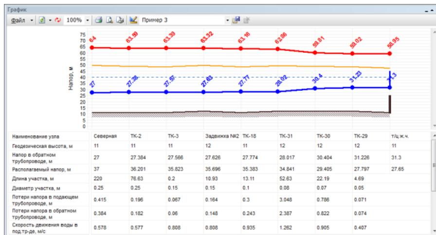
**Рисунок 17.4. Пример пьезометрического графика**
