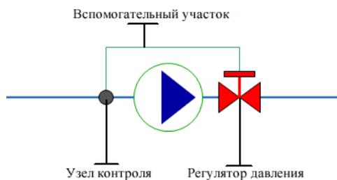
**Рисунок 2.38. Регулятор давления «до себя» на подающем трубопроводе**
