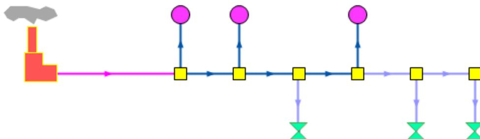
Рисунок 2.26. Пример тепловой сети, работающей на слив
