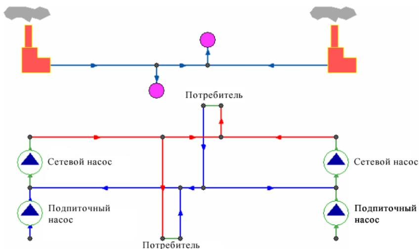
**Рисунок 2.2. Сверху: однолинейное изображение сети, снизу – внутренне представление**
