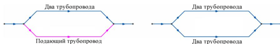
Рисунок 2.6. Изображение трехтрубной и четырехтрубной сети
