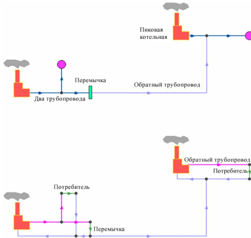
**Рисунок 2.3. Сверху: однолинейное изображение сети, снизу – внутренне представление**
