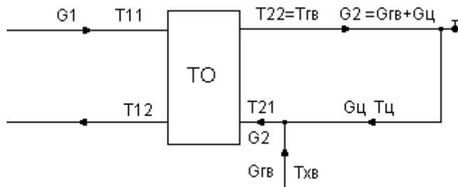
Расчетный расход сетевой воды при работе с циркуляцией для того же теплообменного аппарата будет отличаться от расчетного расхода при работе без циркуляционной линии.
