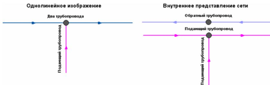
**Рисунок 2.13. Подключение подающего трубопровода к тепловой сети**
