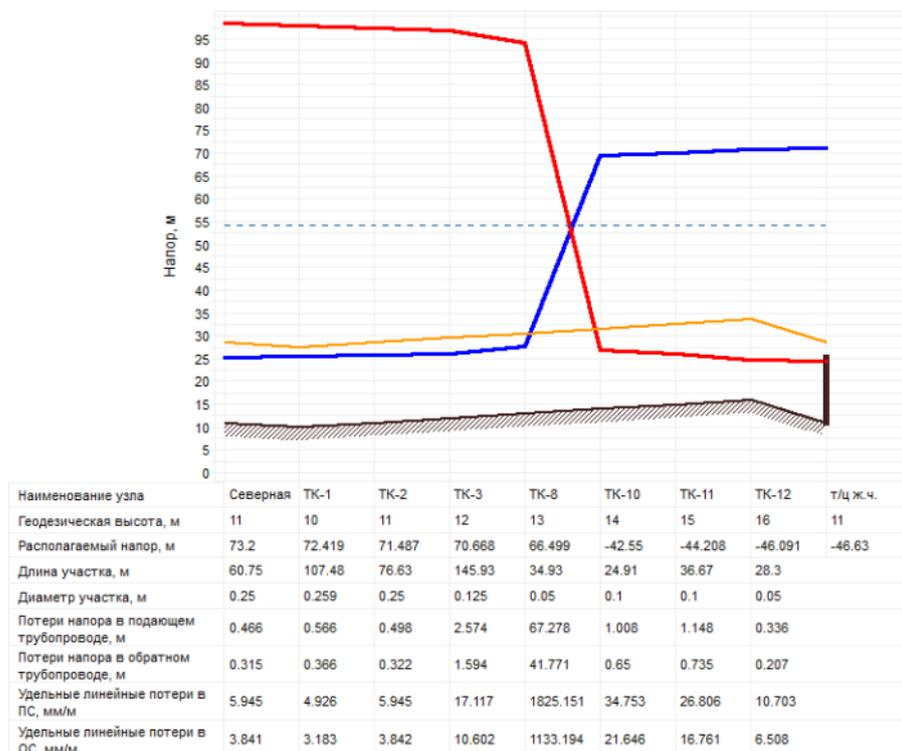
**Рисунок 18.7. Обнаружение ошибки с помощью пьезометрического графика**
