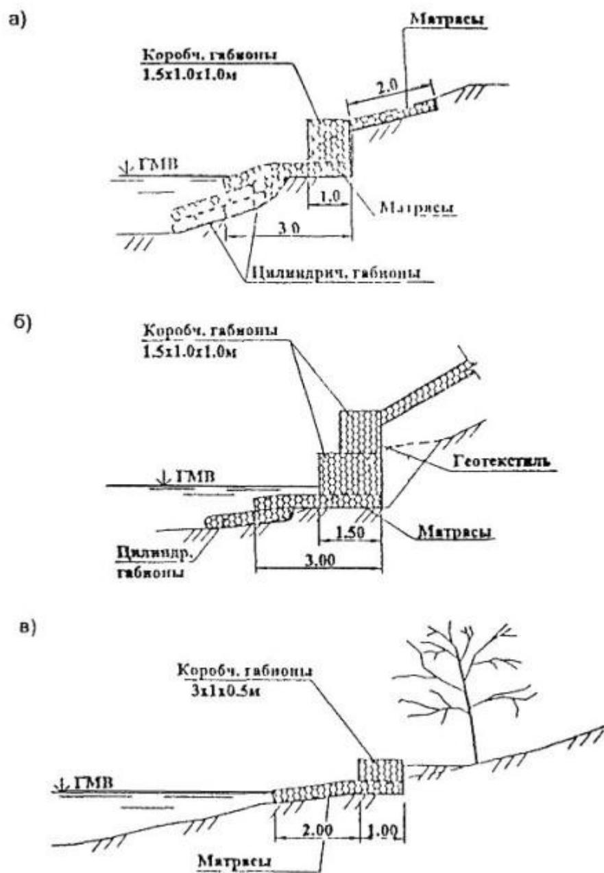
Рис. 4.20. Схемы габионныхукреплений при значительной крутизне пойменно-береговых склонов.
