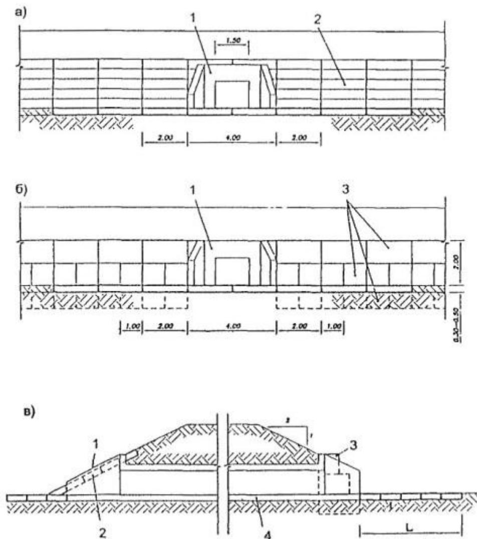
Рис. 6.5. Схемы возможных габионных укрепений верхнего и нижнего бьефов прямоугольных водопропускных труб:
