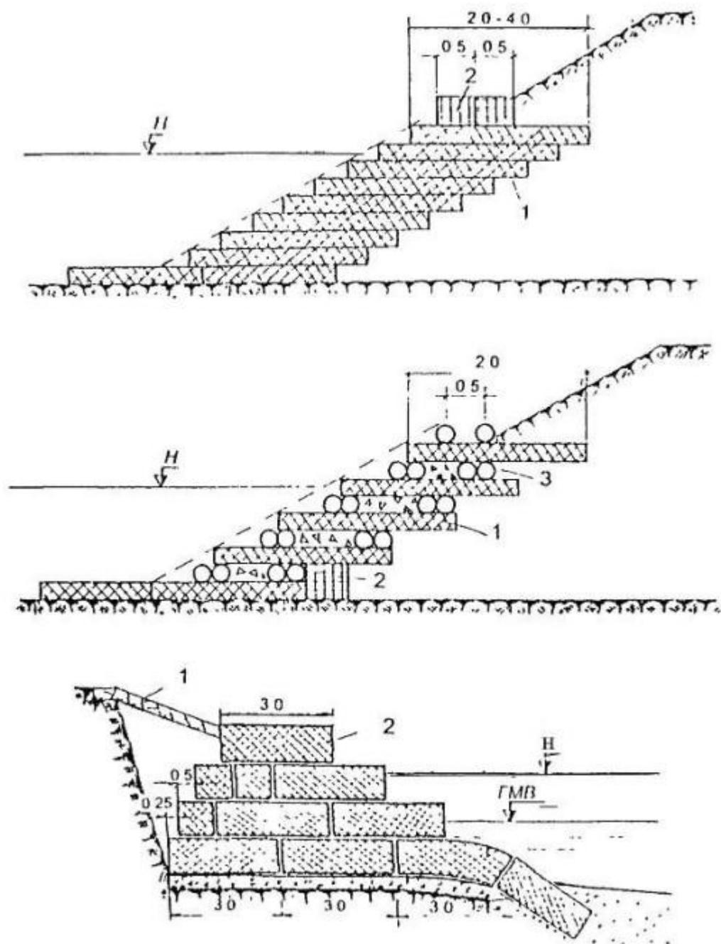
Рис. 4.15. Схемыоткосно-ступенчатых габионов укреплений вдольбереговых сооружений:
