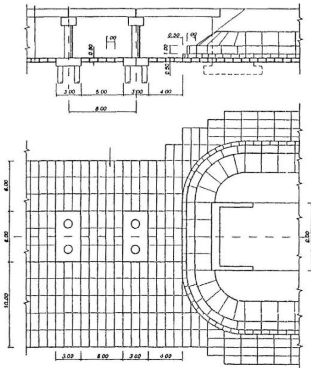
Рис. 4.9. Схема габионного укрепления подмостового пространства и устройство подмостовых конусов ступенчатого очертания.
