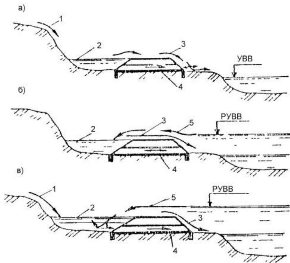
Рис. 7.5. Схемы режимов подтопления вдоль береговых переливных сооружений:
