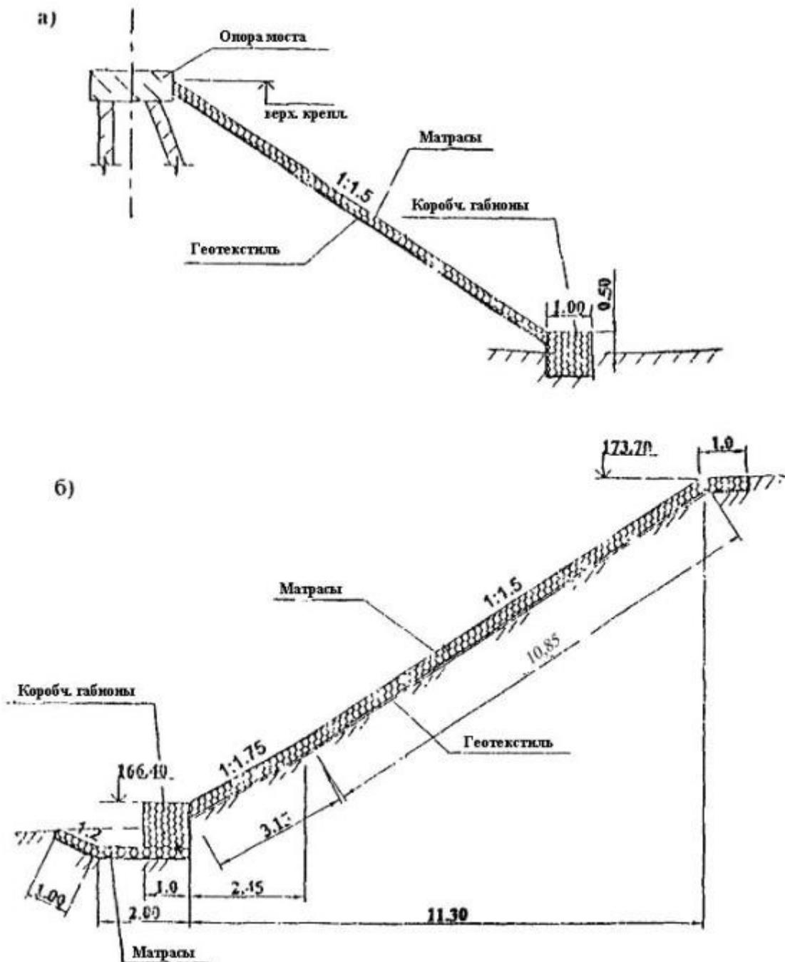
Рис. 3.6. Схемы укрепления неподтопляемых откосов габионными конструкциями:
