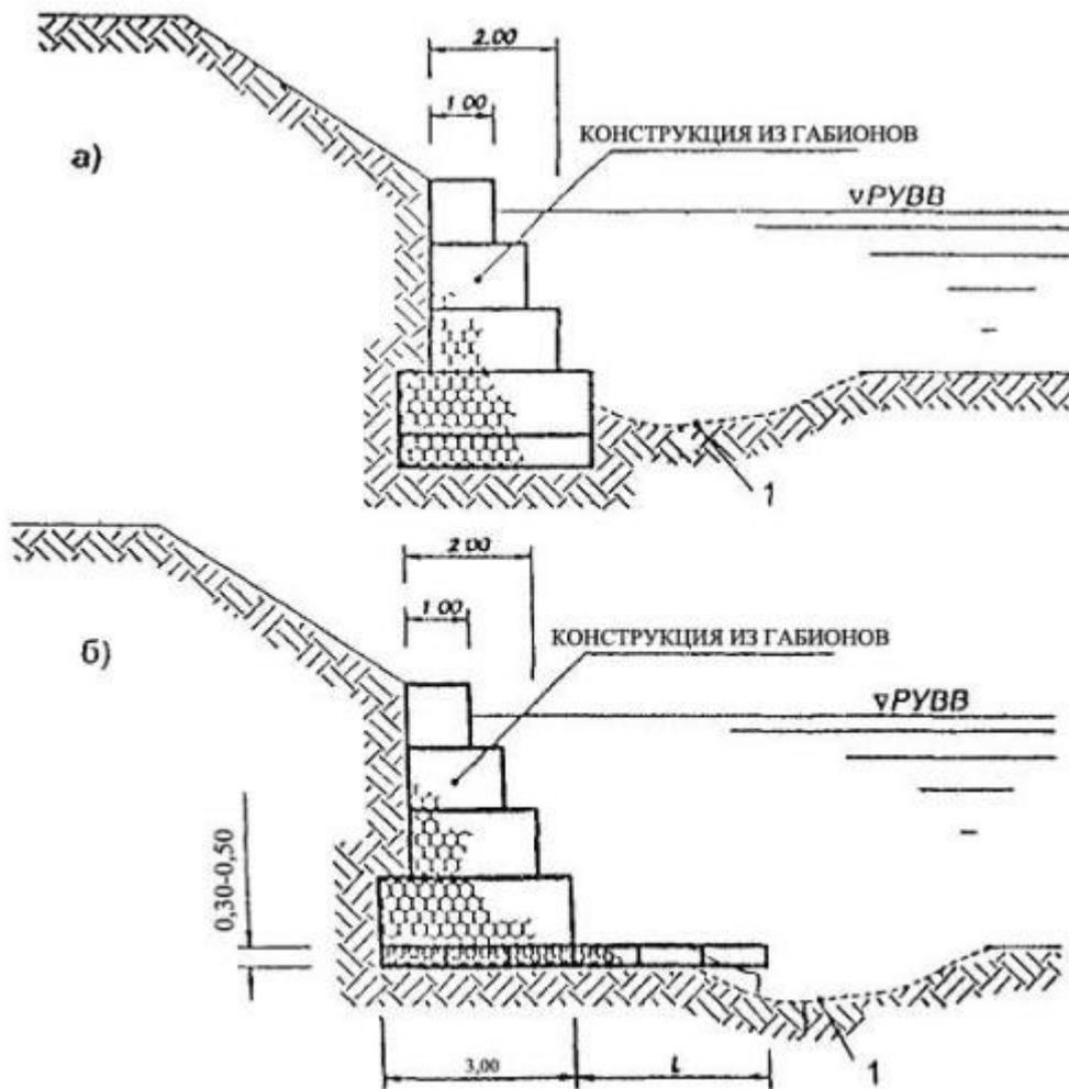
Рис. 4.16. Подпорно-защитные габионные укрепления вдоль береговых сооружений:
