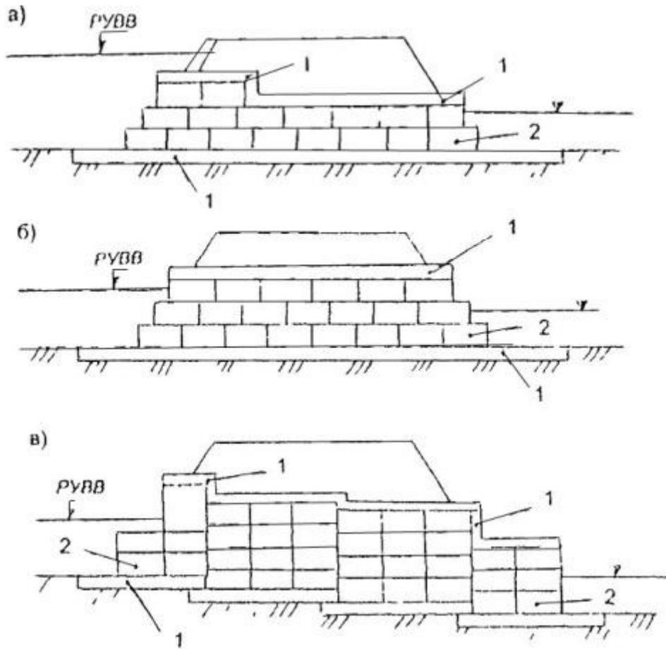
Рис. 7.6. Фильтрующе-незатопляемые насыпи из коробчатых габионов:
