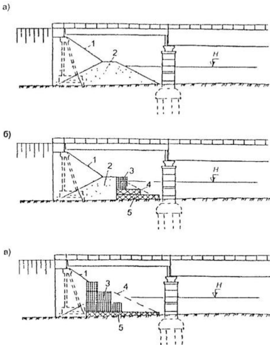
Рис. 4.27. Схемы конструктивных решений по увеличению водопрпускной способности мостов и одновременной защите береговых опор:
