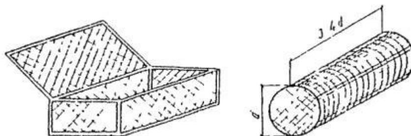
Рис. 2.1. Типы арматурныхкаркасов
