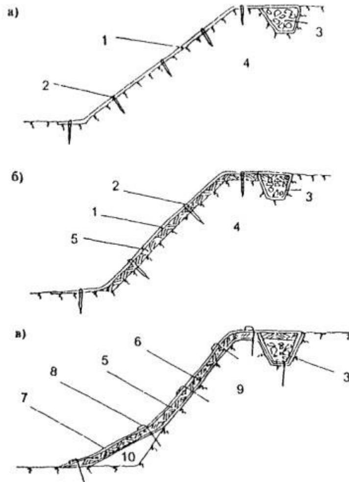
Рис. 3.2. Схемы защиты откосов с помощью биоматов:
