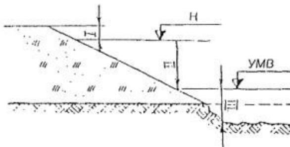
Рис. 3.7. Схема основных частей откосов подтопленных сооружений для вариантных разработок конструкций укреплений.
