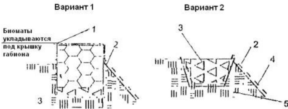
Рис. 3.3. Схема крепления откосов с использованием биоматов и коробчатых габрионов: 1 - открытая крышка габриона; 2 - сетка двойного кручения, привязываемая к габриону; 3 - щебень или гравий; 4 - соломенные биоматы; 5 - геотекстиль.
