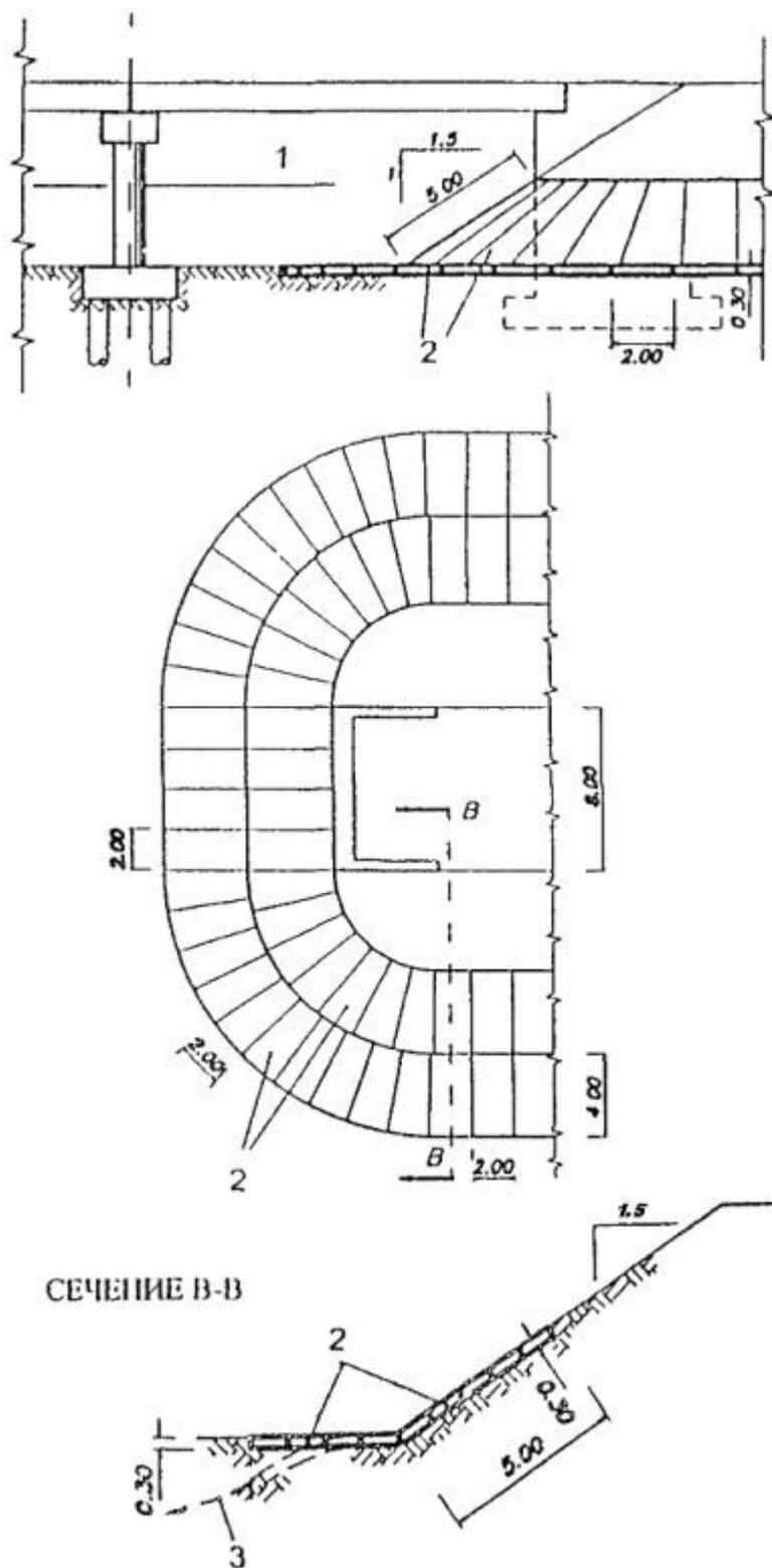
Рис. 4.3. Схема габрионногоукрепления подмостовых конусов, свободно размещаемых в пролетах мостов сразмываемыми руслами:
