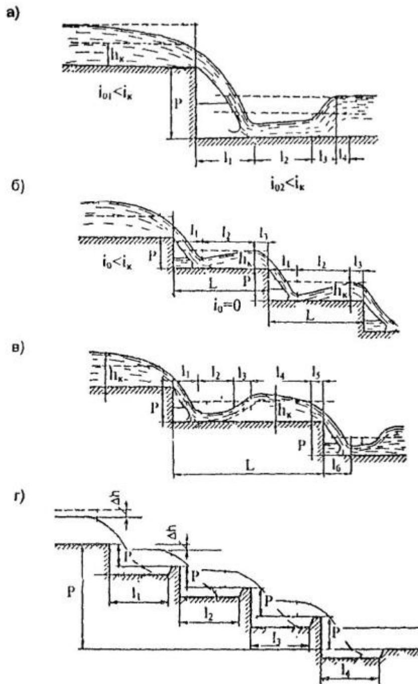
Рис. 6.19. Формы кривых свободной поверхности в перепадах:
