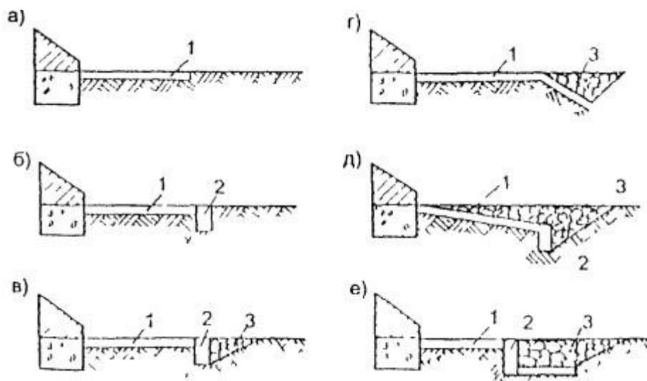
Рис.4.12. Схемы возможных упорно-защитных габионных устройств в концевых частях входных и выходных русел:
