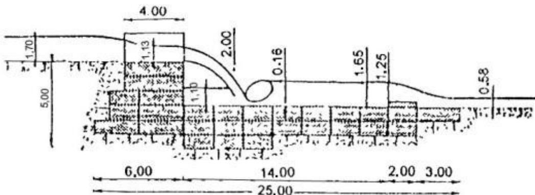
Рис. 7.4. Схема габрионноплотинного порога-водослива для защиты опор мостов от попятного размыва.
