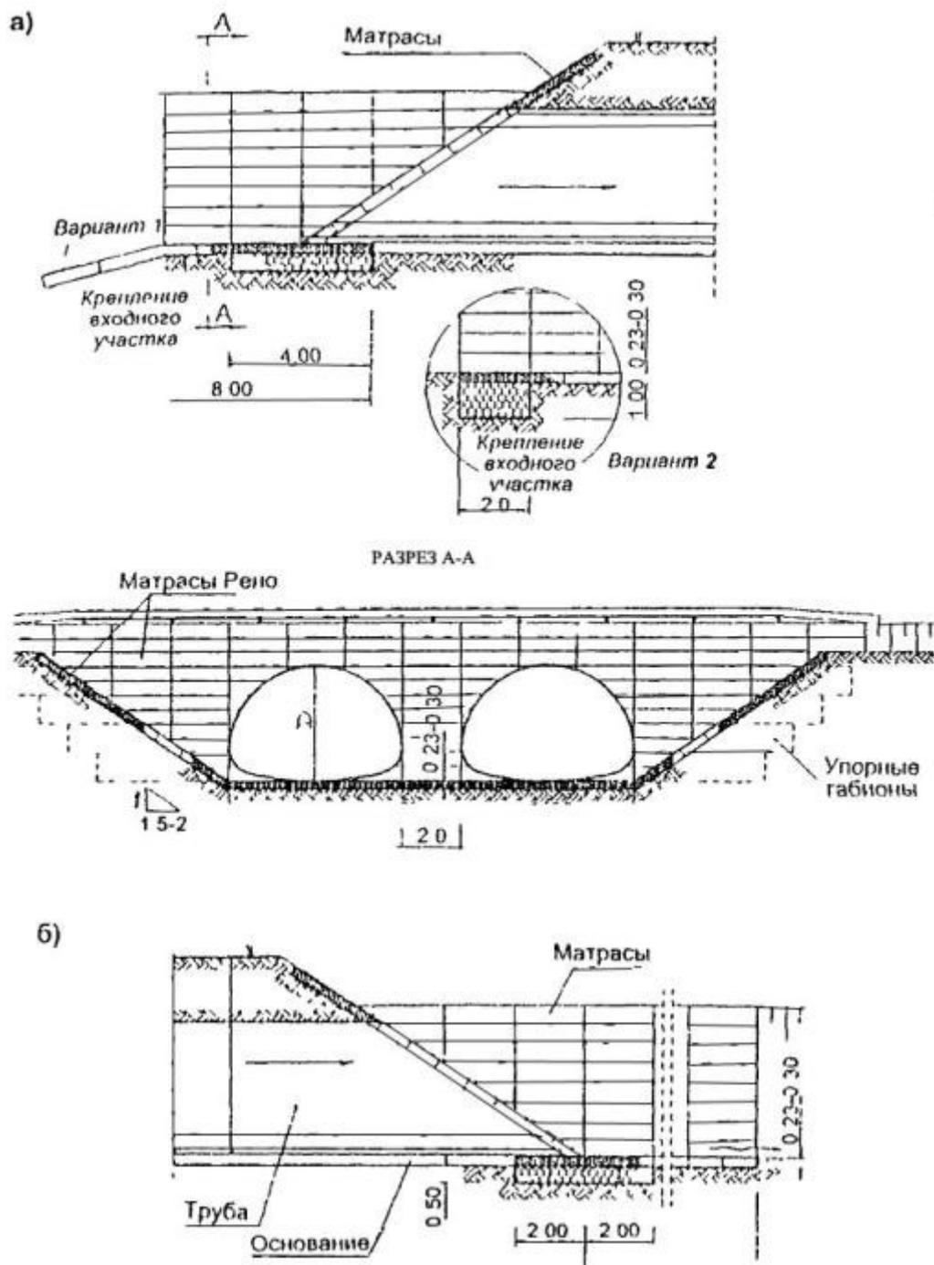
Рис. 6.8. Схемы габионноукрепления верхнего (а) и нижнего (б) бьефов водопропускных труб наклонной подпорной стенкой.
