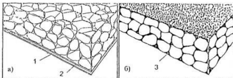
Рис. 2.14. Противофильтрационные и водонепроницаемые габионные строительные блоки:
