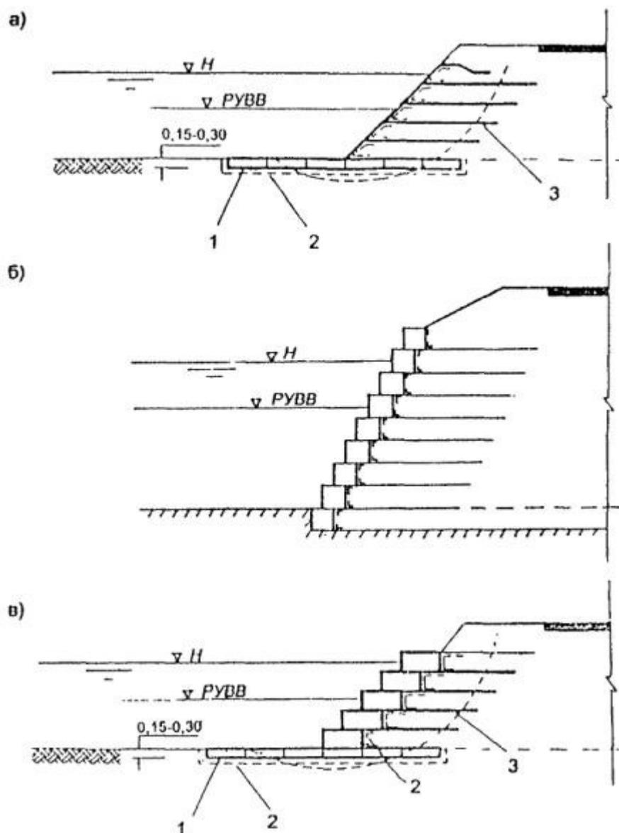
Рис. 3.13. Схемы укрепления средней части подтопляемых сооружений (см. рис. 3.7) при отсутствии межннхвод и размывов у их подошвы:
