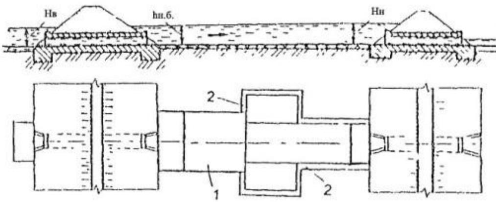
Рис.6.10. Схема противоэрозионного сопряжения пространства между водопропускными трубами, расположенными на близлежащих дорогах или на отдельном дорожном полотне:
