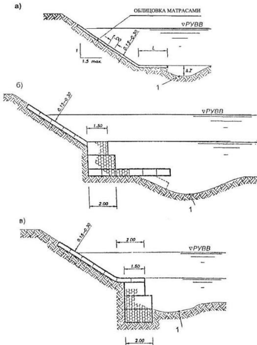
Рис. 4.14. Схемы габионных укреплений вдоль береговых сооружений:
