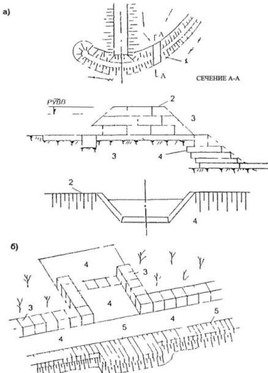
Рис. 4.28. Противоэрозийные габионные водосливы:
