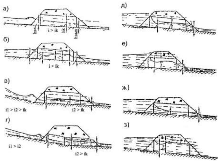
Рис. 6.11. Схемы протекания воды в косогорных трубах.
