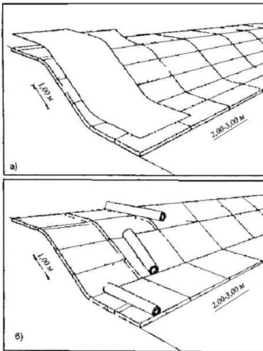
Рис. 2.9. Схемы вариантов укладки сеток крышек матрасно-тюфячных габионов
