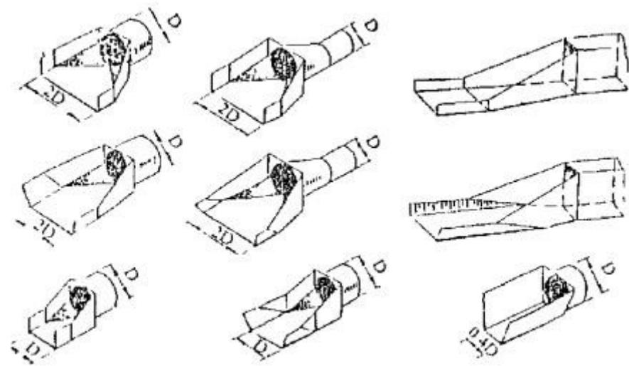
Рис. 6.12. Типы соединений быстротоков с водопропускными трубами.
