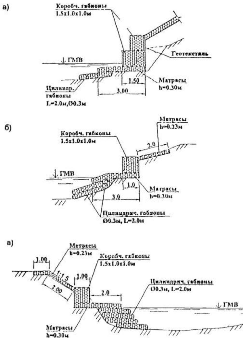
Рис. 3.17. Схемы габионных укреплений для защиты нижней части подтопляемых откосов от подмыва при наличии межвенных вод с применением матрасных, коробчатых и цилиндрических габионов.
