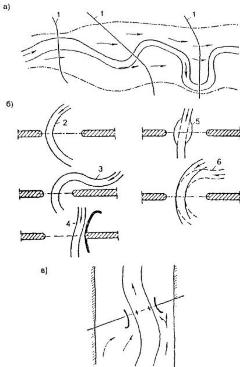
Рис. 3.9. Схемы возможных направлений течения (а) и деформаций подмостового русла через мансардирующую реку (б):
