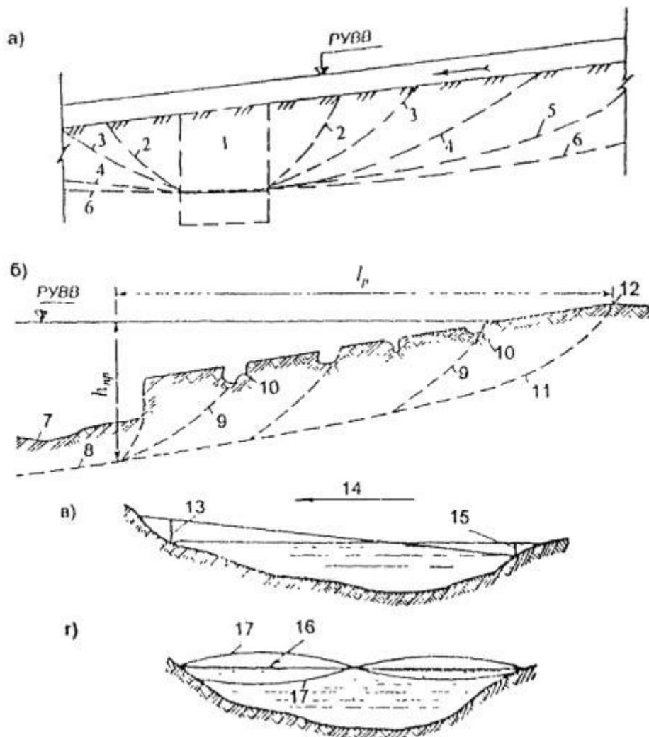
Рис. 3.12. Схемы развития попятного размыва и изменения уроченных поверхностей:
