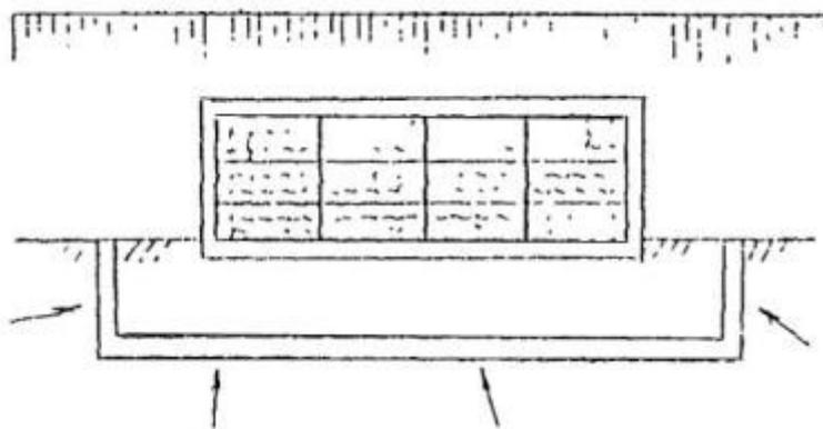
Рис. 7.10. Фильтрующая насыпь ограждающим габионным валом в верхнем бьефе.
