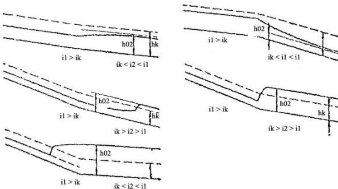
Рис.6.17. Формы кривых свободной поверхности водных потоков в быстротоках (г).
