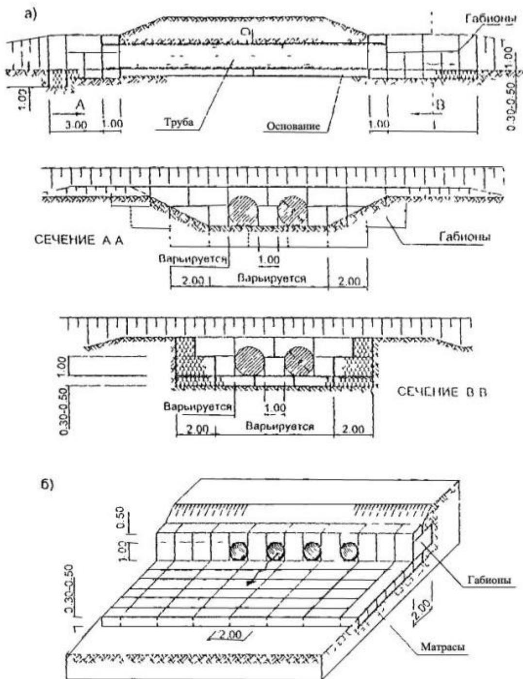
Рис.6.3. Схемы возможных габийонных укреплений верхнего и нижнего бьефов круглых водопроектных труб.
