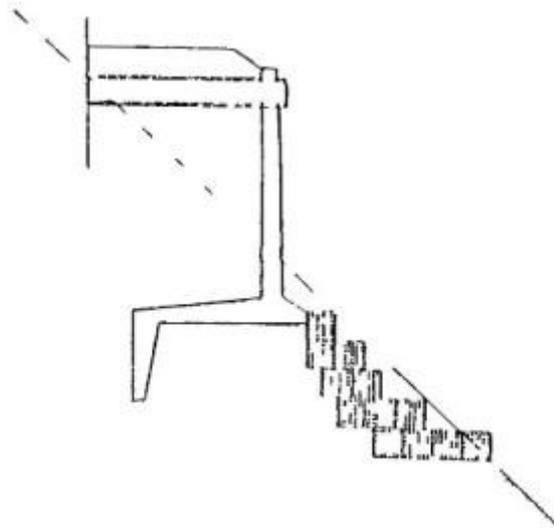
Рис.5.2. Схема габионной конструкции для защиты фундаментов галлерей.
